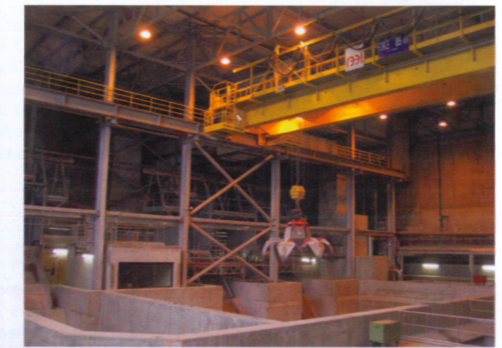
▲ Vue générale des trois skips et du pont roulant pour expédition / General view of the three skips and the gantry-crane for shipping.
