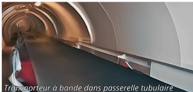
Transporteur à bande dans passerelle tubulaire
