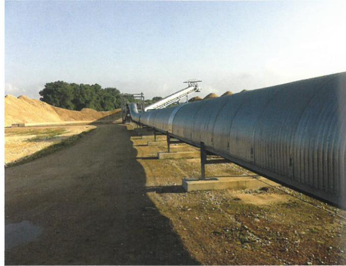
*Convoyeur à bande équipé de capots galvanisés*
