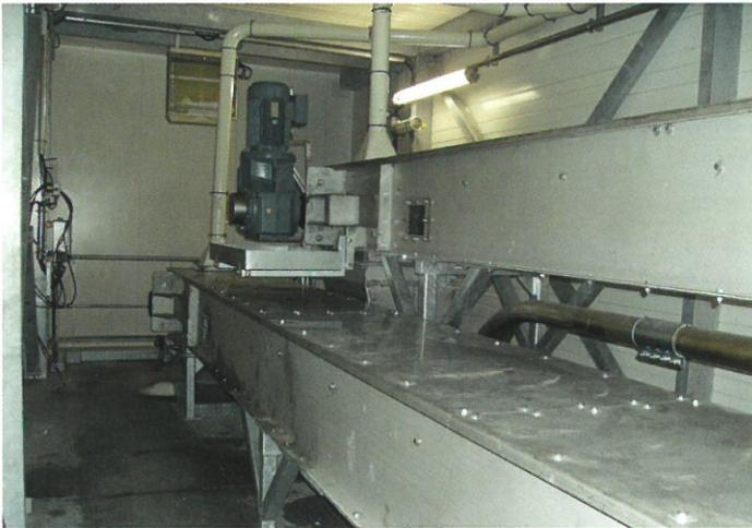
*Convoyeur à chaîne (en masse)*
